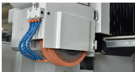
Горизонтальный шлифовальный круг: Ø510x100xØ203.2
