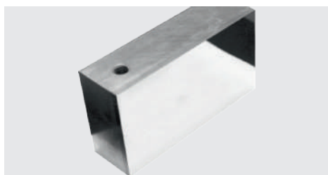
10-ти дюймовая светопроводящая панель Плоскостность: 1,2 мкм Шероховатость: зеркальная поверхность
