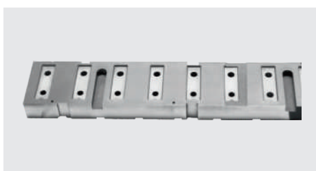
Матрица пресс-формы Плоскостность: 2 мкм Шероховатость: Ra = 0,08
