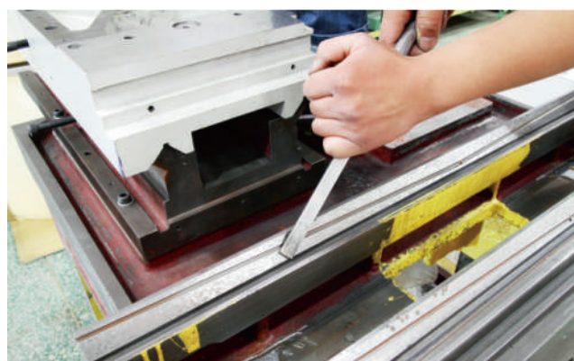
Ручное шабрение поверхности направляющих
