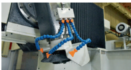
Вертикальный шлифовальный круг: Ø355x50xØ127
