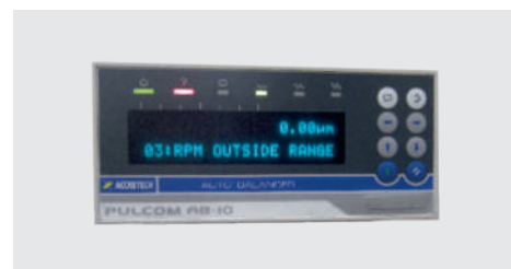
Динамическая балансировка шлифовального круга
